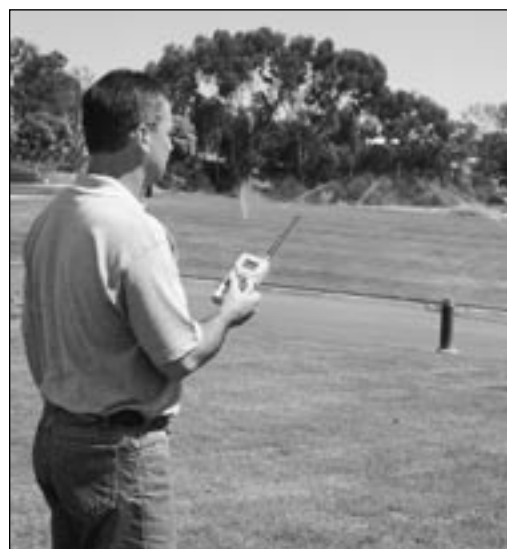
Ponga los aspersores en marcha desde una distancia máxima de 3,21 km (2 millas) del programador.
